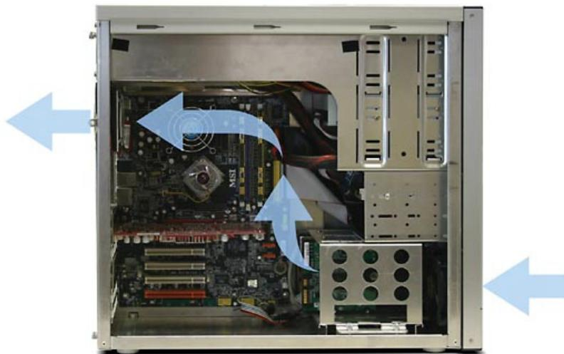
فنها را در جلو و پشت جعبه سیستم نصب کنید تا یک جریان پیوسته هوای خنک در داخل سیستم به وجود بیاید.
